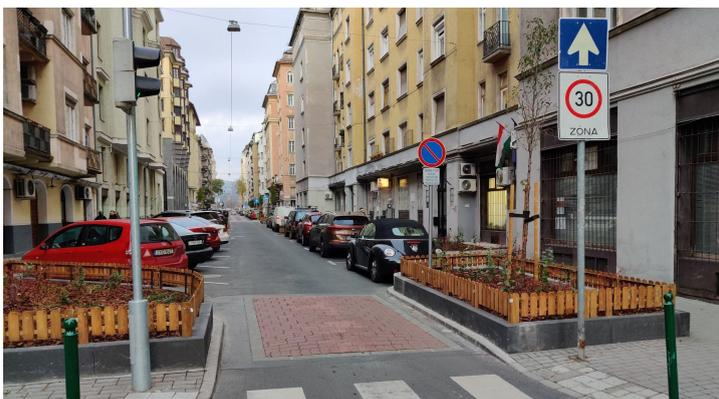
Abb. 4: Einbahnstraße in Budapest mit schmaler Fahrgasse, eingefasst durch blau-grüne Infrastruktur, barrierefreie Überwege und neugeordnete Stellplätze (Foto: QIMBY)
