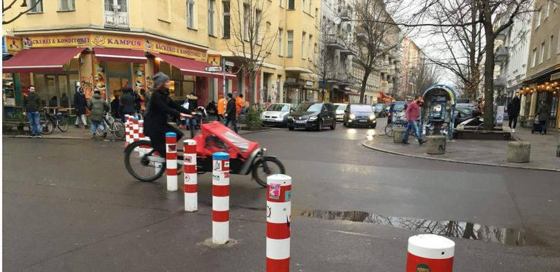
Abb. 3: Bereits ein einzelner Diagonalfilter kann die Verkehrsströme im gesamten Superblock zugunsten des Umweltverbunds verändern. In von Fußgängern viel genutzten Bereichen sollten Poller von taktilen Bodenbelägen eingefasst werden. (Foto: I. Lechner)
